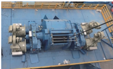
图3 4600 kW两挡高载重比较车
