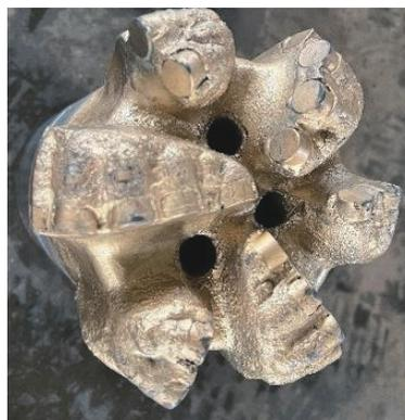
(a) 常规1308复合片+孕镶柱复合结构0152mm全面钻头
