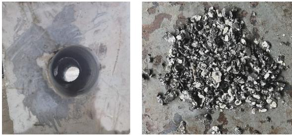
图 10 试验用砂岩块和钻出的岩屑
