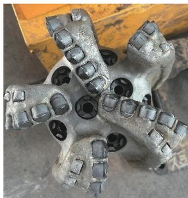
(b) 1308奔驰齿+孕镶柱复合结构0215.9mm全面钻头
