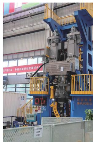
图5 DQ150BSD顶驱装置<sup>[23]</sup>
