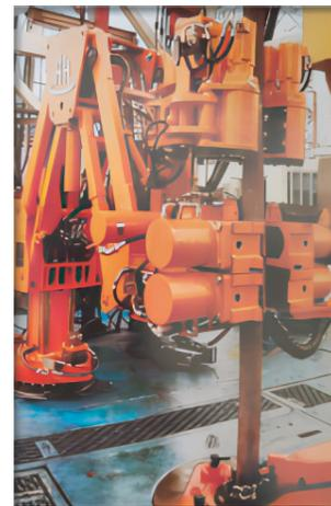
图7 宏华TP100铁钻工(来源于百度)
