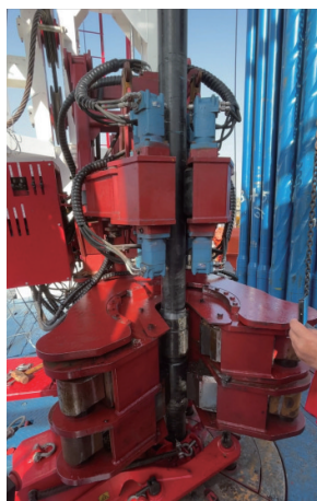
图9 冲扣钳现场试验
