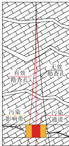
图1 勘查孔与污染通道示意
