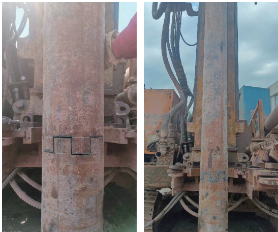
图5 矩形齿嵌入焊接长套管
