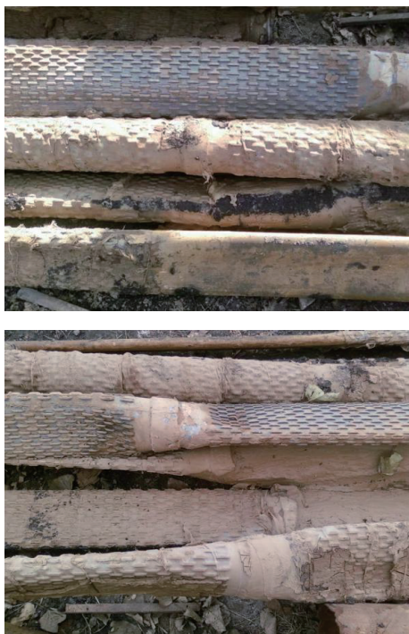
图1 河南原阳县1200 m地热井事故过滤管钻井液堵塞情况
