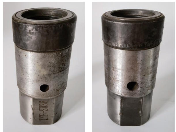
图3 涡轮振动器小样与滚珠振动器小样外观
