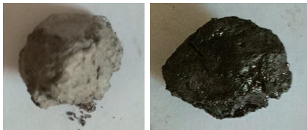
(a) 浸泡前 (b) 浸泡9天后 图6 成膜防塌无固相冲洗液浸泡试验
