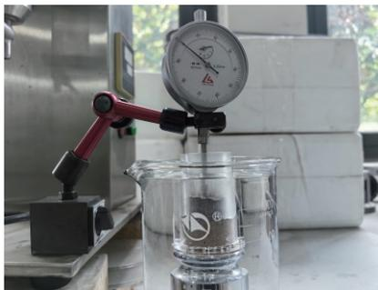
(b)岩心线性膨胀量试验
