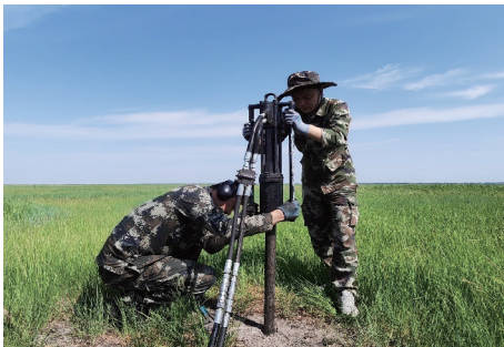
图3 背包钻野外施工
