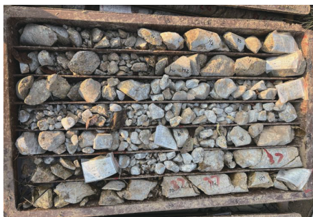
图1 河南省灵宝市崤山矿区破碎地层岩心
