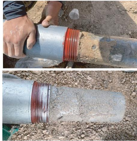
图3 岩粉造成岩心管与钻具外管间隙堵塞
