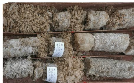
图2 石盐地层中的孔隙(裂隙)
