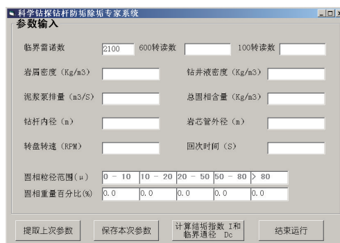
图1 科学钻探钻杆防垢除垢专家系统
