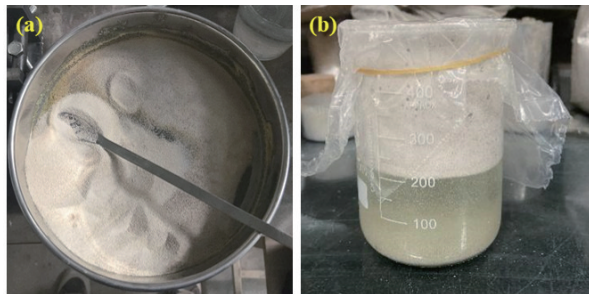
(a) 玻化微珠-I (b) 浸泡硅烷偶联剂 图2 玻化微珠-I及浸泡硅烷偶联剂
