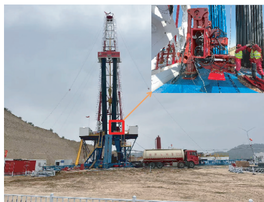
图8 RN254型铁钻工野外生产试验
