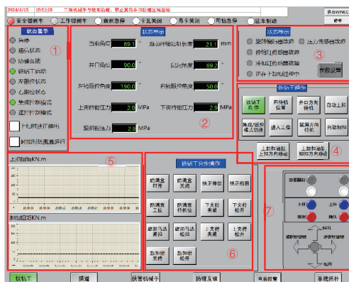
图6 司钻房上位机HMI主界面
