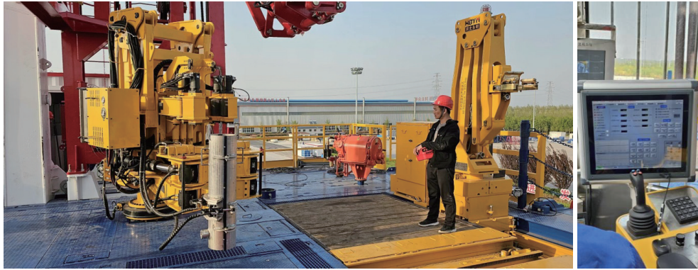
图9 RN254型铁钻工与钻机厂家集成应用
