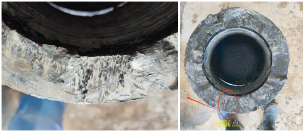
图8 钻铤刺漏断裂截面
