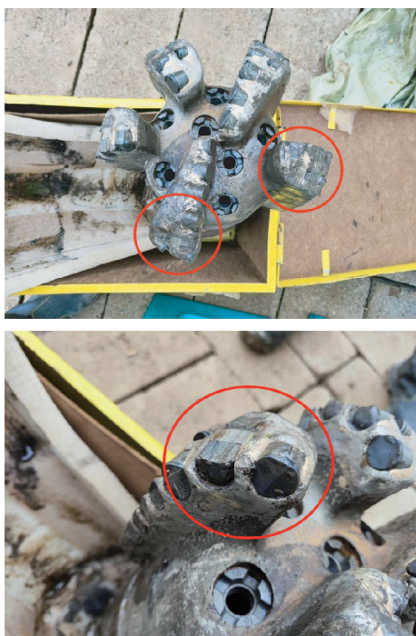
图4 硅质灰岩段钻头切削齿磨损情况
