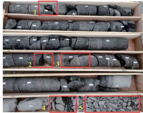
图7 某回次获取的 \text{O}119\text{ mm} 岩心 4.24\text{ m}
