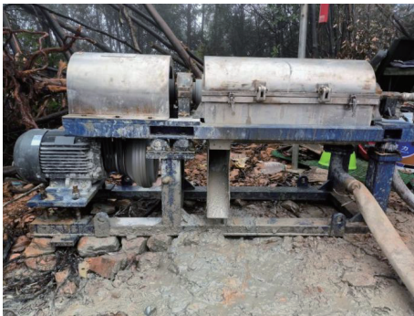
图4 使用钻井液离心机分离有害固相
