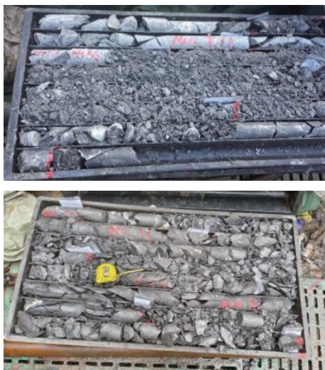
图1 粉砂质灰岩与千糜岩化碎裂岩岩心
