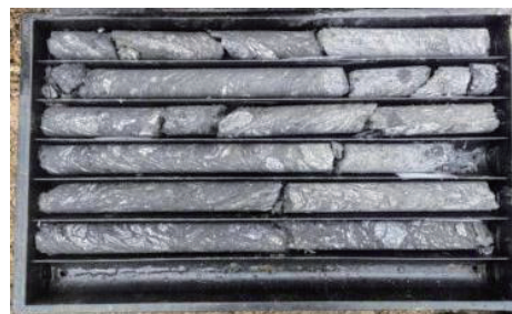
(b)三层管取心工艺采取岩心
