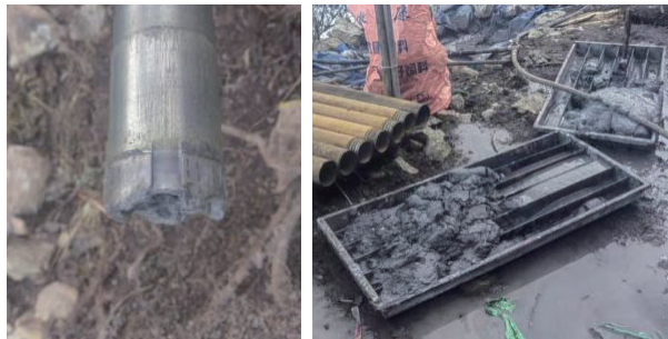
图5 复合片合金钻头与无泵捞取的钻孔垮塌堆积物
