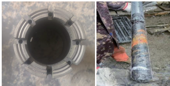
图3 底喷钻头与三层管取心
