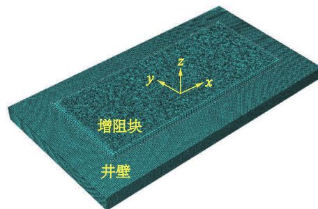
图5 增阻块与井壁的接触作用网格模型
