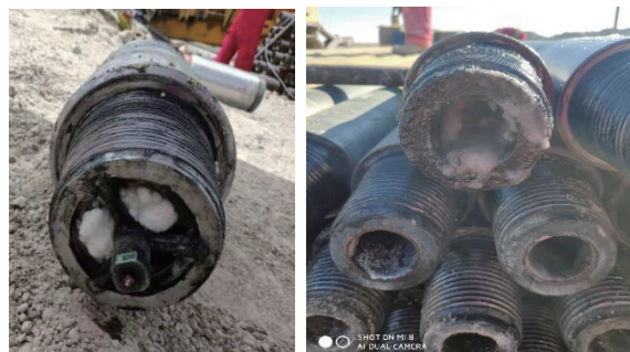
图8 结晶堵塞的钻杆泥浆通道
