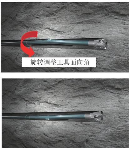
图8 旋转调整螺杆马达工具面向角示意
