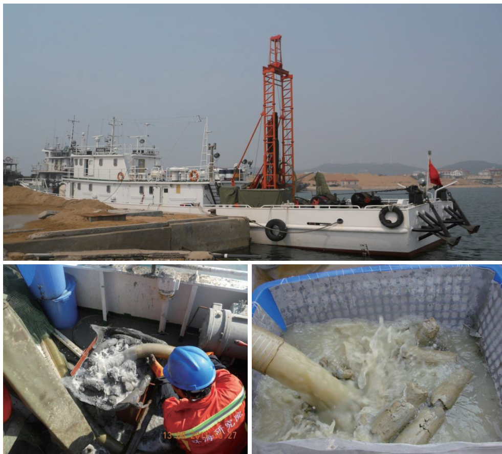
图1 水力反循环连续取心钻探技术在近海海洋钻探取样施工现场
