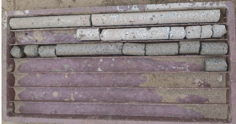
(d)PDC八刀翼取心
