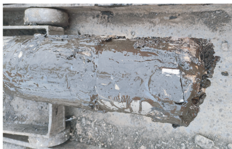
图6 严重泥包的钻头及钻具
