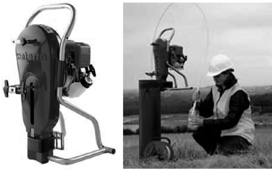
图 4 Waterra 公司设计的背负式惯性泵
