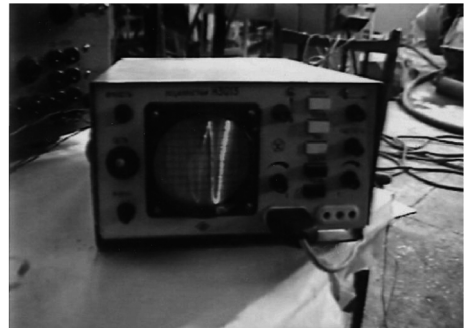
图7 Q=70 \text{ L/min} 条件下,电阻 R=7.7 单位,冲洗液 \rho=230 \text{ kg/m}^3 时的示波情况
