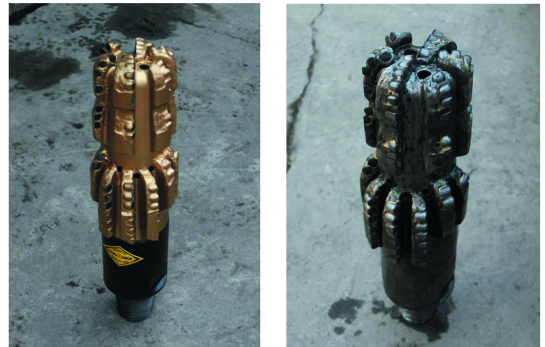
(a) 入井前的双心钻头 (b) 磨损后的双心钻头
