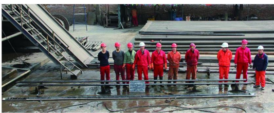
图 6 三开 31 回次 9.0 m 半合管取出的 8.94 m 长岩心
