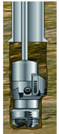
图4 套管下扩孔钻进
