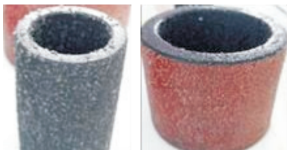
图 2 亚硫酸氢钠溶液中试件表面的结晶体
