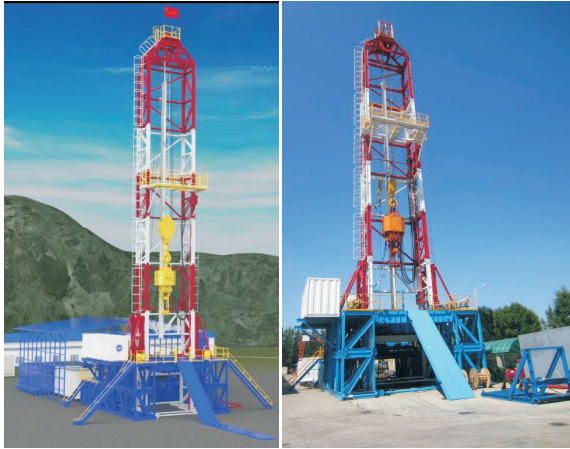
图1 4000 m地质岩心钻机三维效果及实物外形
