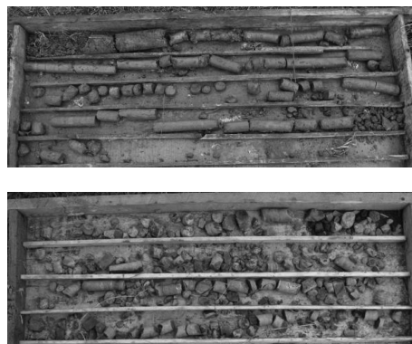
图4 浅钻绳索取心工艺取心效果
