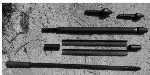
图1 改进后的TGQ-5C型冲击钻机及钻具
