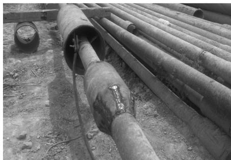
图7 反丝钻杆提升时的专用导向罩子
