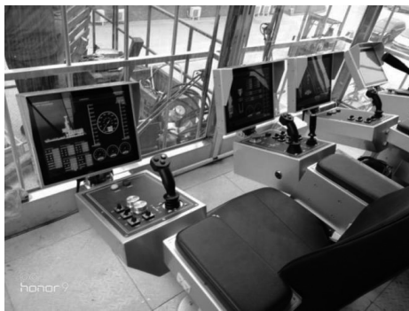
图3 CMD150S型钻机司钻房
