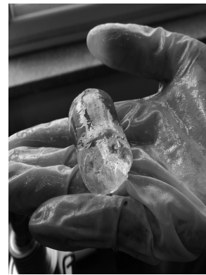
图11 在一定温度下形成的堵漏用凝胶样品
