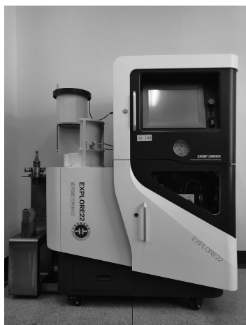
图8 Super HTHP Rheometer 2018超高温高压流变仪实物
