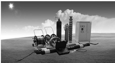
图1 地下水分层抽水系统
