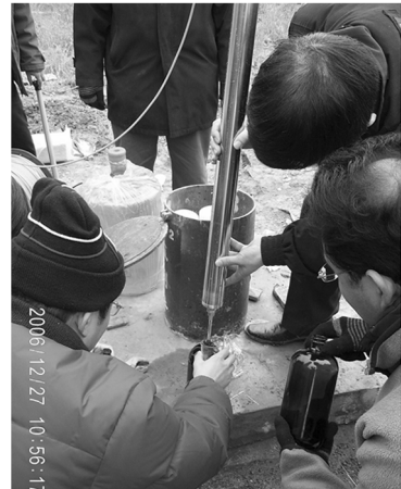
图 3 定深取样器取样现场
