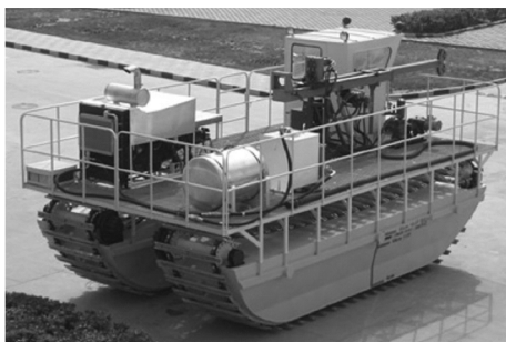
图1 “海勘一号”HK-1型全液压轻便钻机图片
