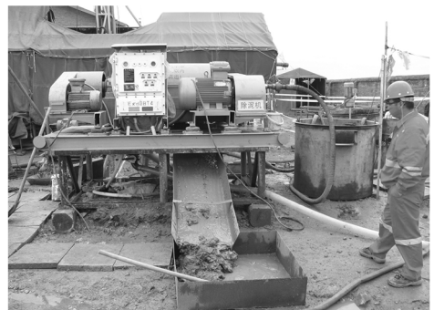
图4 LW-400型离心式除泥机除泥现场
