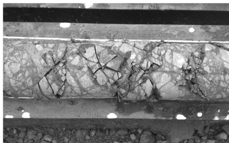
图1 火山凝灰岩的破碎岩心
