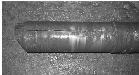
图5 被断层泥胀开的半合管
