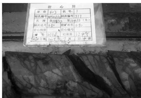
图6 长石英砂岩中的地震裂纹
