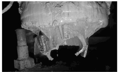
图 4 炸断后提出的钻杆断面
