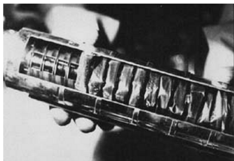
图6 带岩心的柔管在卷鼓上缠绕的实物图
