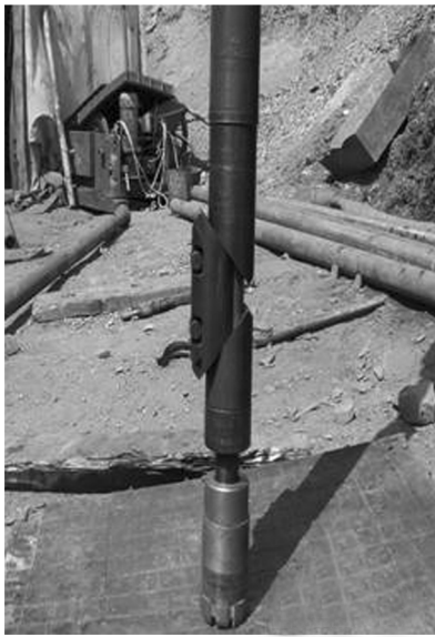
图2 LZ-73连续造斜器实物图
