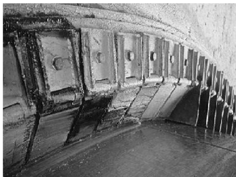
图 4 折页式密封压板
