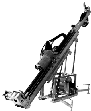
图1 ONRAM1000/3型钻机主机
