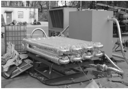
图5 钻井泥浆冷却系统组成
