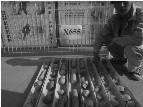
图 4 掺加氯化钙后第二次旋喷试桩成桩后钻心取样
