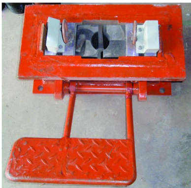
图 3 BS75-J 加重型闭式木马夹持器
