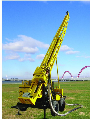
图1 YDX-3 型全液压力头钻机
